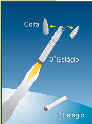
Figura 4.58. Separação do 2º estágio, ignição do 3º estágio e ejeção da coifa.
