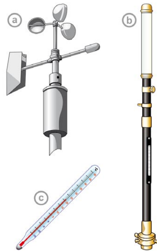
Figura 5.11. Exemplos de instrumentos de medição: a) anemômetro, b) barômetro e c) termômetro.
