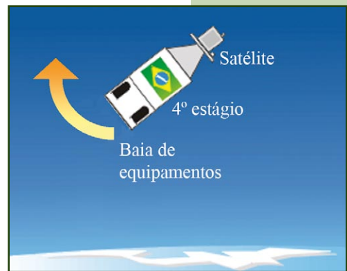
Figura 4.59. Manobra de basculamento do VLS-1.
