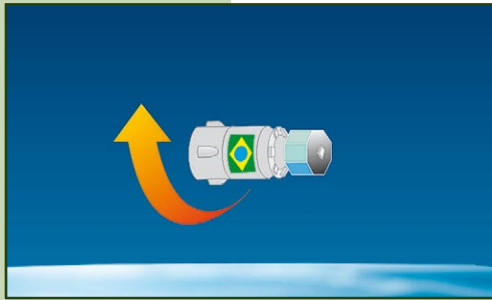
Figura 4.60. Indução de rotação do VLS-1.
