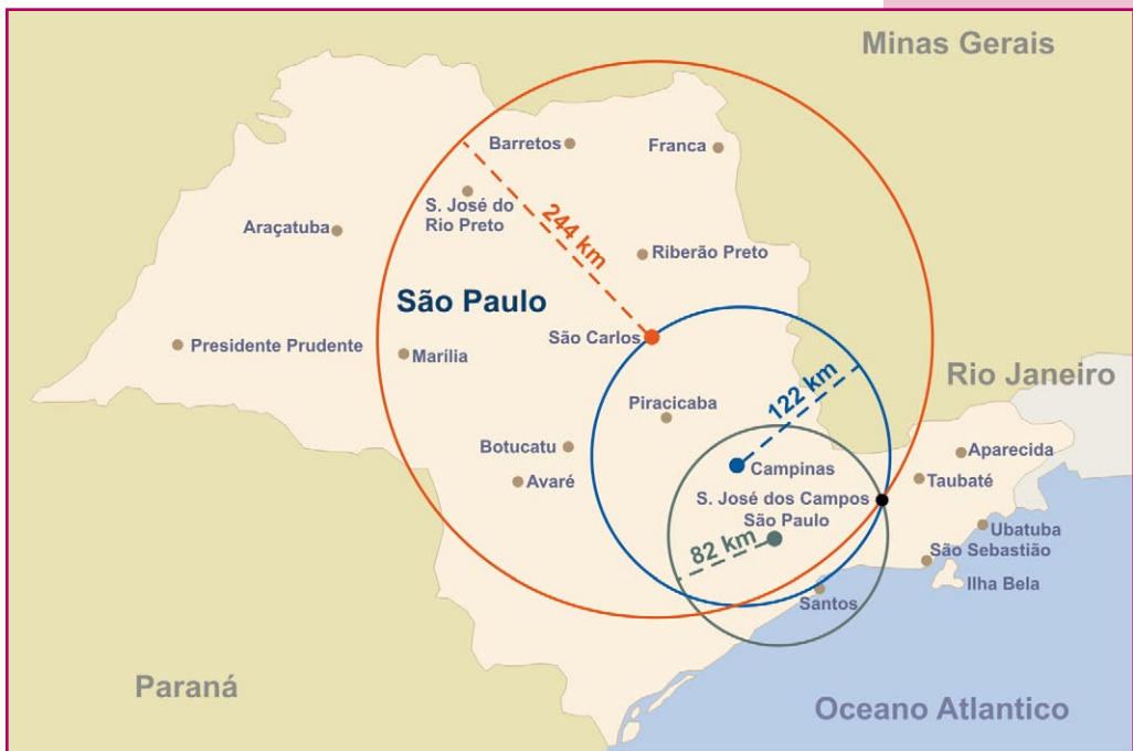
Figura 5.38. Princípio da trilateração em duas dimensões.
