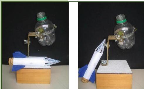
Figura 4.84A e B. Foguete fixado à rolha junto a um modelo de plataforma.
