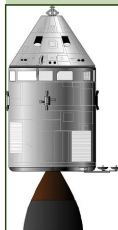
Figura 4.70. Módulos de comando e serviço da Apollo.
