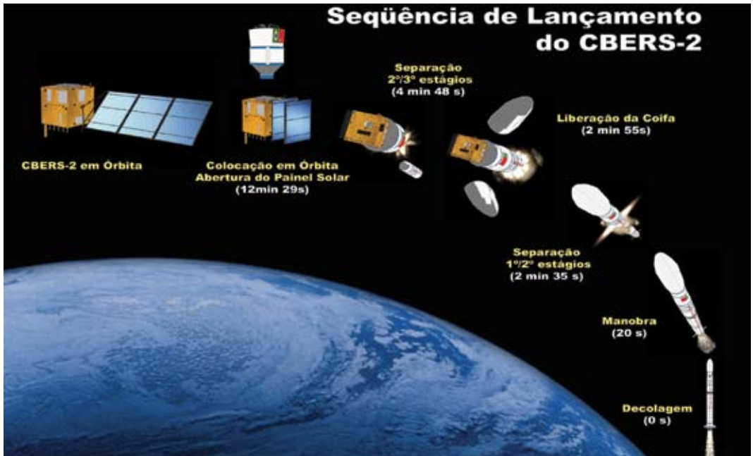
Figura 4 - Seqüência de lançamento do CBERS-2
