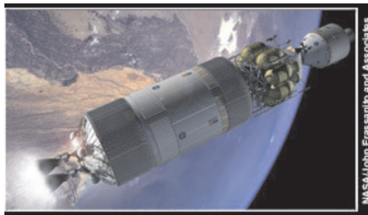
Figura 1.41c. Acoplamento da Cápsula-Módulo de Serviço ao Foguete-Módulo Lunar já em órbita, com posterior acionamento do foguete rumo à Lua.
