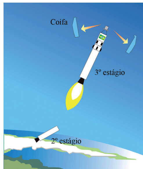
Figura 2.21. Separação do 2º estágio, ignição do 3º estágio e ejeção da coifa.
