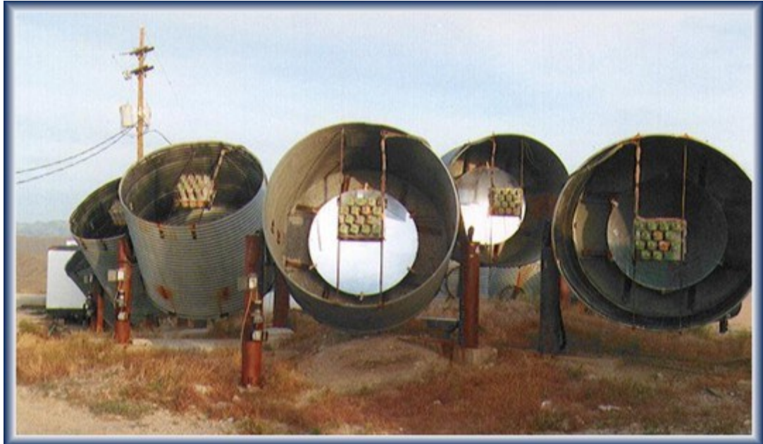
Figura 14: Telescópio olho de mosca.
