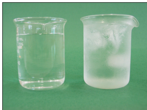
Figura 6. Verificando a presença de vapor d'água no ar.
