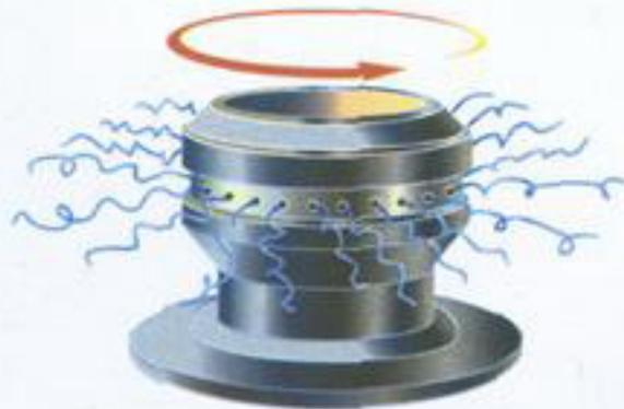
**3** Ao girar, a cabeça metálica joga açúcar contra a parede interna da câmara. O açúcar passa do estado sólido para o líquido graças ao calor da resistência. Ao sair pelos furos e entrar em contato com o ar, ele volta ao estado sólido em forma de fios de cristais.
