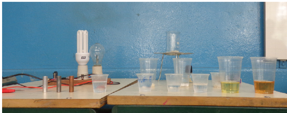
Figura 3 - Materiais para experimento de condutibilidade elétrica das substâncias.
