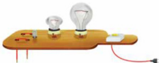
Figura 1 - Sistema de três lâmpadas de diferentes potências.
